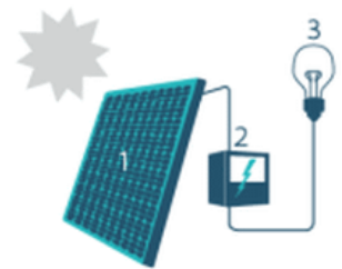
1. Zonnepaneel | 2. Omvormer | 3. Elektrische toestellen
